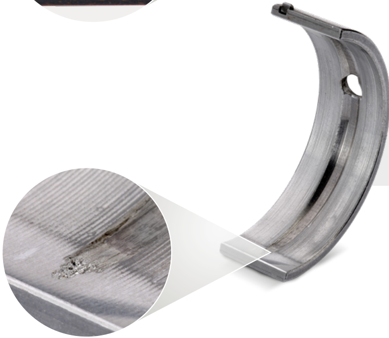
Üst ana yatak kovanları, çelik-alüminyum bileşik malzeme
