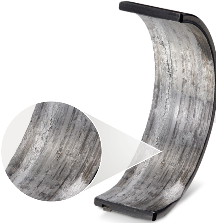
Alt ana yatak kovanı, çelik-alüminyum bileşik malzeme
